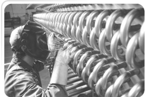
استفاده از لوله استیل و فین آلمینیوم اروپایی در کویل های این شرکت و انجام جوشکاری صحیح و تست آن در شرایط فشار  $500\text{ ps}i$  و مقاومت کششی و مقاوم در برابر خوردگی بالای لوله های استنلس استیل و فین های آلمینیوم ضربه اطمینان بالا و عمر چند برابر را برای اواپراتورهای این شرکت فراهم می آورد.
